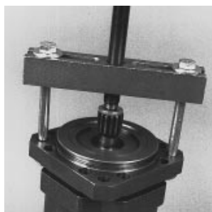
Fig. 50-3 - Remove Flange (SAE)
